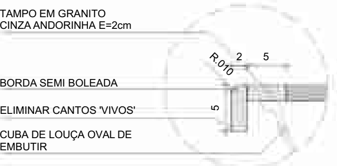
DETALHE 5 - CORTE Bancada de granito - cuba de embutir esc.: 1/5
