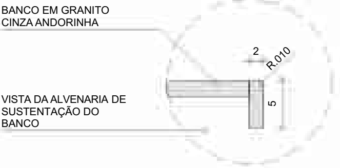
DETALHE 4 - CORTE Banco de granito esc.: 1/5
